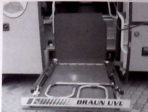
Winda do wózka - podnośnik elektrohydrauliczny do wprowadzania wózka umieszczony pod podłogą przy tylnych drzwiach.
